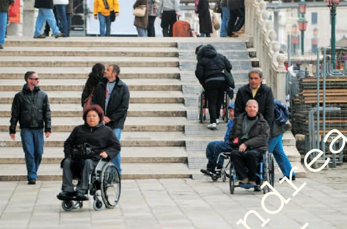
Venezia, Ponte della Paglia. La rampa è costituita da una pedana componibile in elementi di materiale plastico trattato antiscivolo. Per la facilità di montaggio e per la sua totale reversibilità, può rappresentare una soluzione per varie situazioni in cui sia necessario superare uno o due gradini, sia all'interno che all'esterno di edifici storici.
